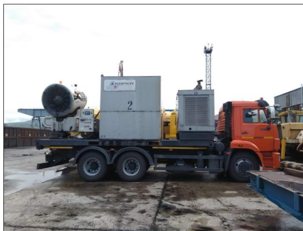
Рисунок 4-2. Мобильная установка водяного тумана и снегогенератор в зимнее время года
