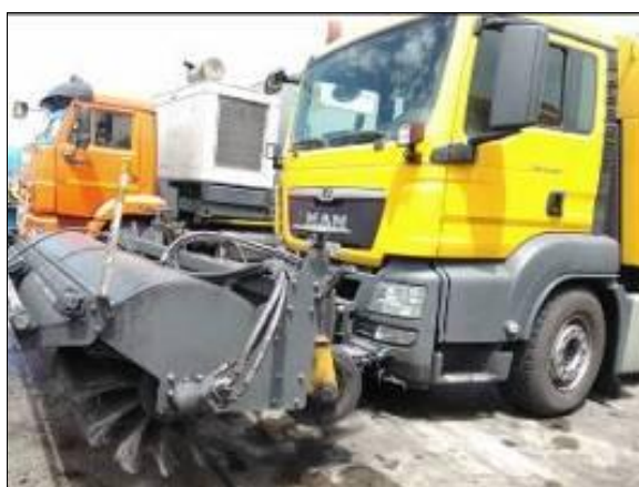
Рисунок 4-9. Вакуумная ПУМ KRS 90/95. Щетки и всасывающее устройство
