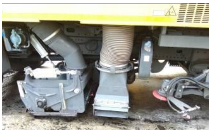
Рисунок 4-9. Вакуумная ПУМ KRS 90/95. Щетки и всасывающее устройство
