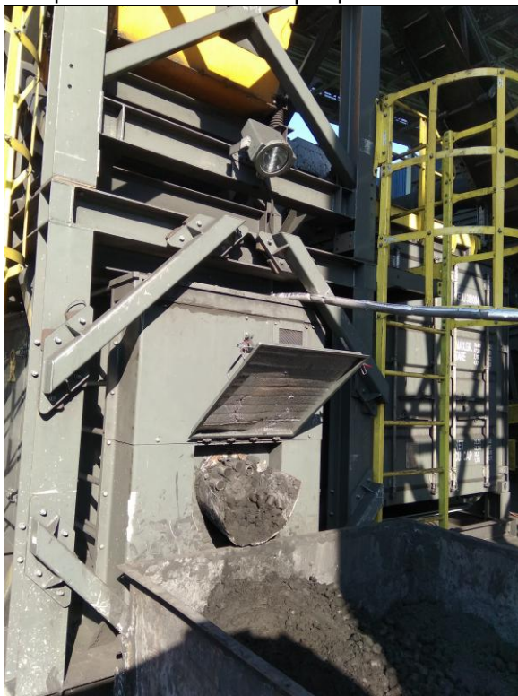
Рисунок 4-1. Установка для брикетирования угольной пыли
