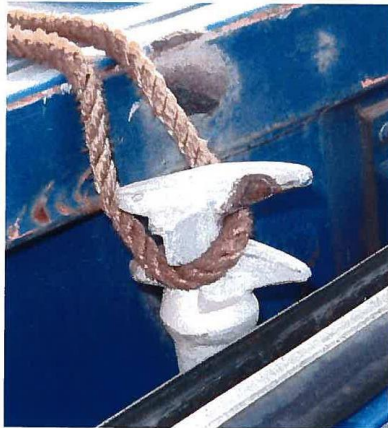
Рис.3. Крепление створок дверей.
